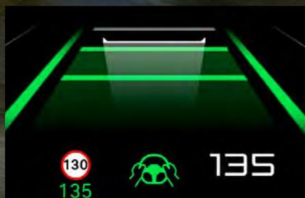
L'Highway Driver Assist\*, dispositivo di guida semi-autonoma di II Livello, combina il Cruise Control Attivo con funzione Stop & Go con il Lane Keeping Assist. Il conducente non deve più occuparsi della velocità e della traiettoria del veicolo, poiché tali funzioni vengono gestite autonomamente dall'auto; affinché i sistemi rimangano attivi, le mani del guidatore devono rimanere sul volante.
